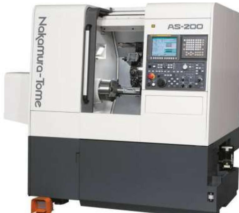
Das 4-Achsen-Dreh-/Fräszentrum AS-200 des japanischen Herstellers Nakamura-Tome ermöglicht uns ein kompaktes Kraftpaket für die Komplettbearbeitung sowohl bei kleinen Serien als auch bei der Massenproduktion komplexer Teile zu gewährleisten.
